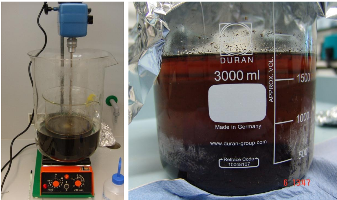
Abbildung 5: Behandlung der Klärschlammprobe unter ständigem Rühren mit 10 molarer Natronlauge. Nach der Neutralisation mit Salzsäure setzten sich Sande und Salze ab. Die Dichte der Flüssigkeit wies 1,14 \text{ g cm}^{-3} auf und enthielt somit alle leichteren Kunststoffe (v.a. PE, PP, PS, PA). Durch Dekantieren der Probe wurden diese auf einem 10 \mu\text{m} Filter gesammelt und weiter behandelt
