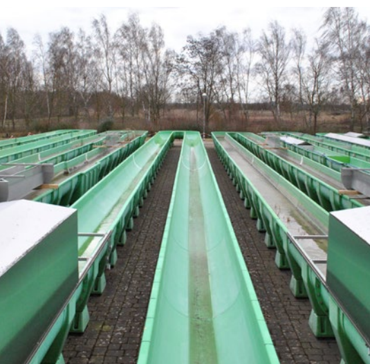
Mesokosmen sind meist vereinfacht aufgebaute und teilgeschlossene experimentelle Anlagen zur Simulation naturnaher Bedingungen.
