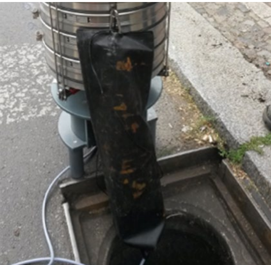
Probenahmekorb zur Beprobung von Straßenkehrriecht.
